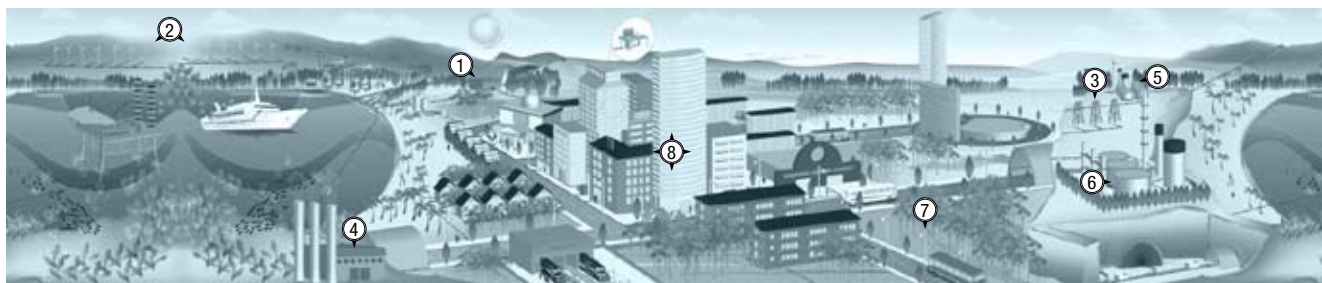
1- Usina hidroelétrica | 2- Parque eólico | 3- Linha de transmissão | 4- Usina termoelétrica | 5- Subestação abaixadora 6- Indústria de grande porte | 7- Rede de distribuição | 8- MetrÓpole: consumidor residencial, comercial e industrial
